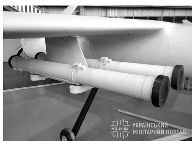
Підвіс для керованих ракет на БПЛА «Сокіл-300»
