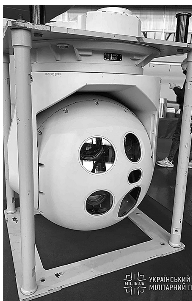
Оптико-електронна станція для БПЛА «Сокіл-300»
